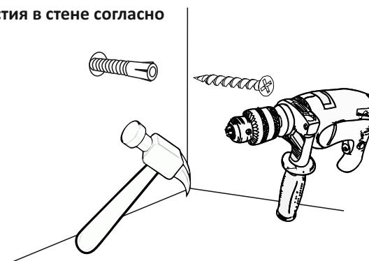
Внимание! В комплектацию входит дюбель, предназначенный только для бетонных и кирпичных стен. Для гипсокартонной стены дюбеля подобрать самостоятельно, а так же изготовить усиленный каркас для правильного распределения нагрузки тумбы.
