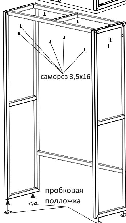
Присоединить каркас к системе хранения с помощью саморезов 3,5x16.
