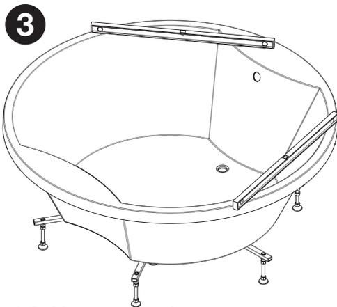
Установите ванну на опоры. Строительным уровнем проверьте горизонтальность, если необходимо произведите регулировку положения опор. Опоры должны равномерно касаться пола.
