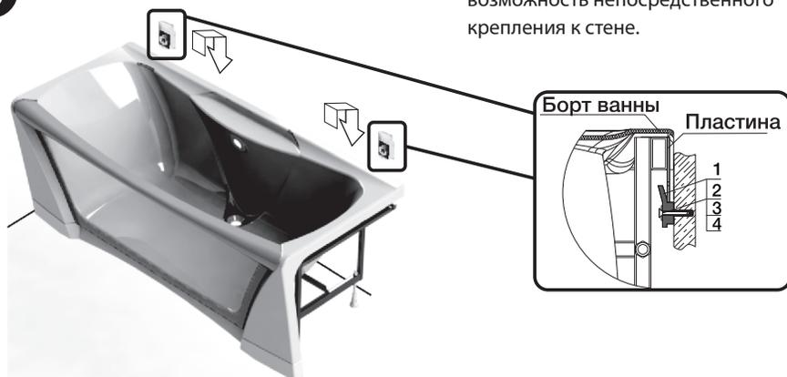
Аккуратно установите ванну, цепляя пластину за крючки. Крепежная пластина рамы также предусматривает возможность непосредственного крепления к стене.
