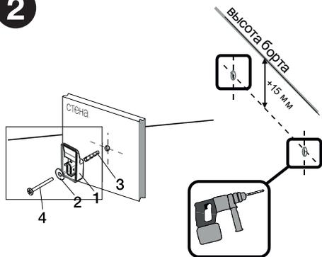
В месте установки ванны отметьте отверстия для монтажных крючков. Отодвинув ванну, просверлите отверстия в стене, прикрепите монтажные крючки 1 к стене, используя крепеж 2,3,4 входящий в комплект.
