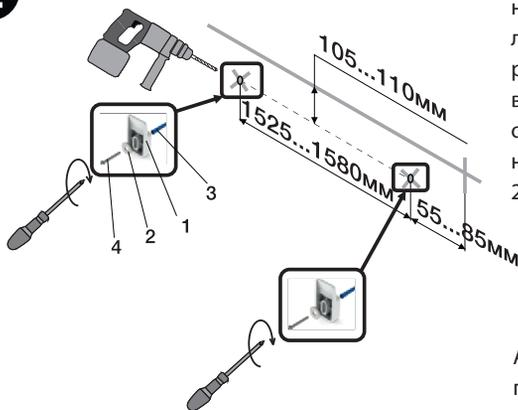
Наметьте места для установки монтажных крючков под горизонтальной линией на расстоянии 105...110 мм и на расстоянии 55...85 мм и 1525...1580 мм от вертикальной линии. Просверлите отверстия в стене, прикрепите монтажные крючки 1 к стене, используя крепеж 2, 3, 4, входящий в комплект (2).
