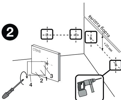
В месте установки ванны отметьте отверстия для монтажных крючков. Отодвинув ванну, просверлите отверстия в стене, прикрепите монтажные крючки 1 к стене, используя крепеж 2, 3, 4, входящий в комплект (2).
